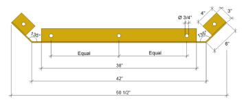
DOUBLE SIDED TAPERED WRAP AROUND RIGHT AND LEFT TAPERED ANGLE- 48"
